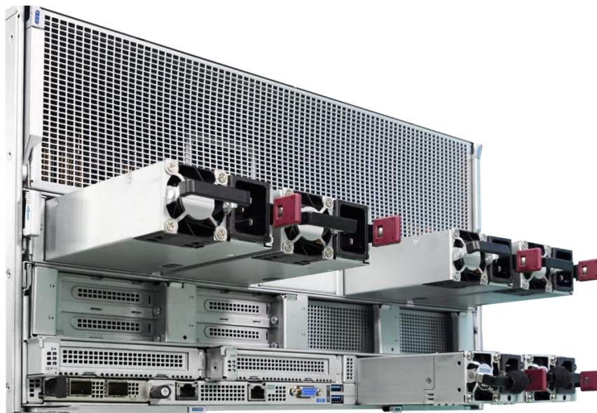
图5 R5500 G5 后部电源双平面
