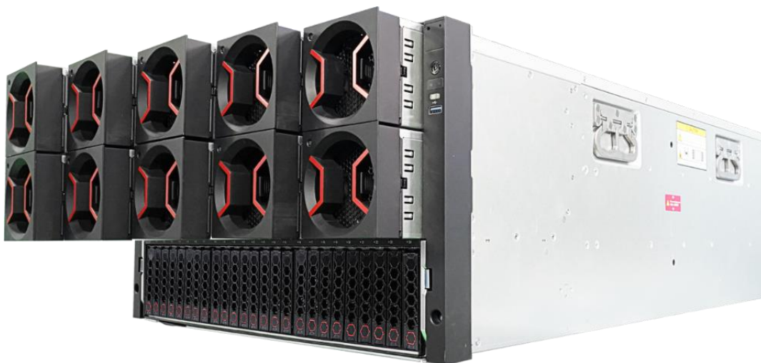
图6 R5500 G5 前部高性能风扇模块细节图
