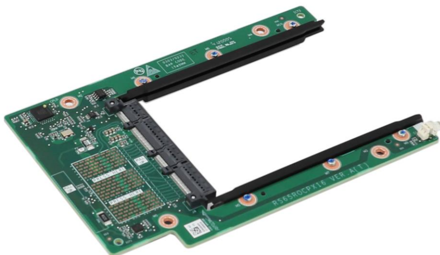
图45 型号 2：支持 multihost 功能的 OCP 转接卡
