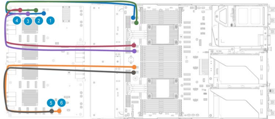
图6-8 8port 配置数据线缆 2
