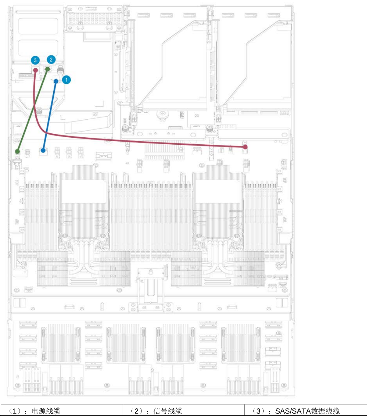
图6-4 后置 2SFF 硬盘线缆
