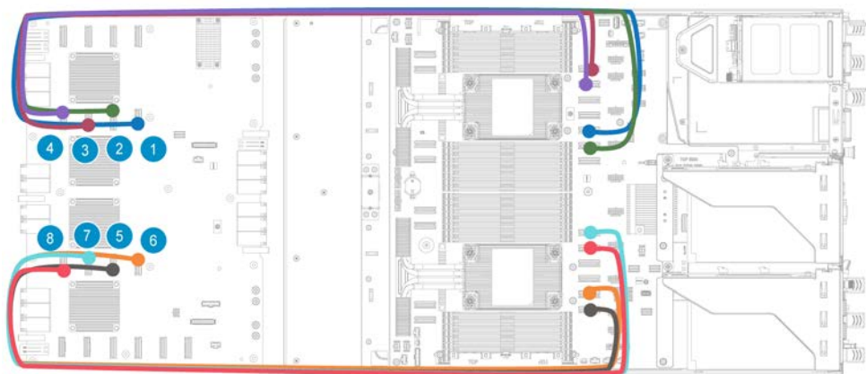
图6-7 8port 配置数据线缆 1
