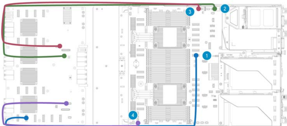
图6-6 Switch 板到主板的必配线缆
